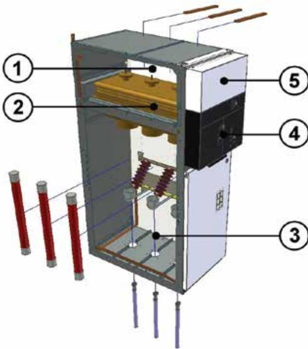
**1. Recinto de barras:** Se ubica en la parte superior y forma un compartimiento continuo con las demás celdas acopladas.
